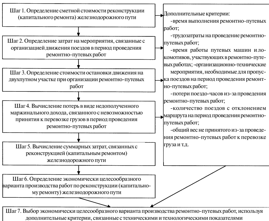
Рисунок 2 – Пошаговая модель расчета затрат на выполнение работ по реконструкции и капитальному ремонту железнодорожного пути
